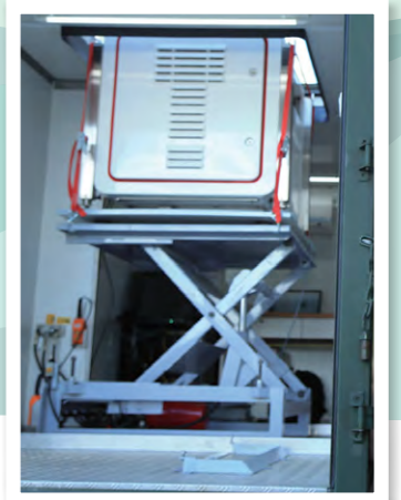
車載式剖風儀 可觀測5000公尺以下的大氣中低空層風象。
