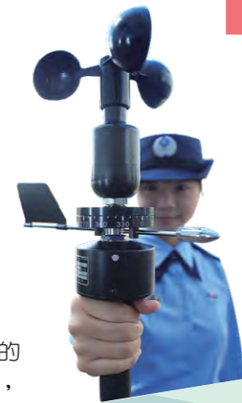
手持風向計 可測量出準確的風向和風速。
